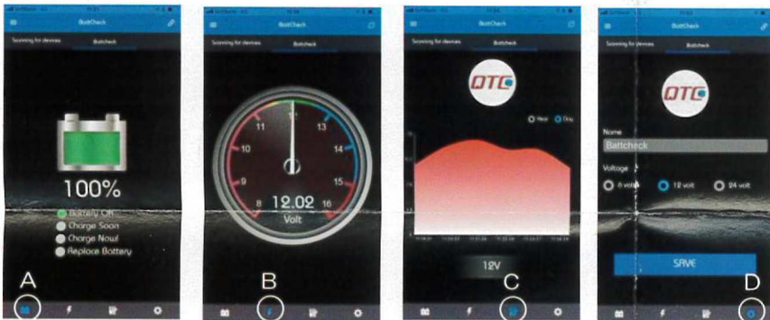
A: バッテリーチェック B: 電圧メーター C: 電圧記録 (年/日) D: 設定ページ
