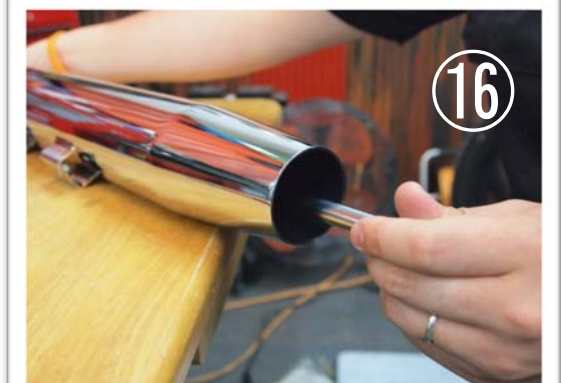
16 工具を時計回しに回してナットを締める
