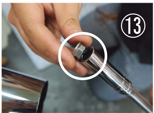
13 12mmソケットにロックナットを付ける
