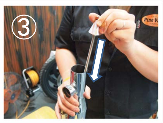
マフラー内部の中央穴にボルトを通す
