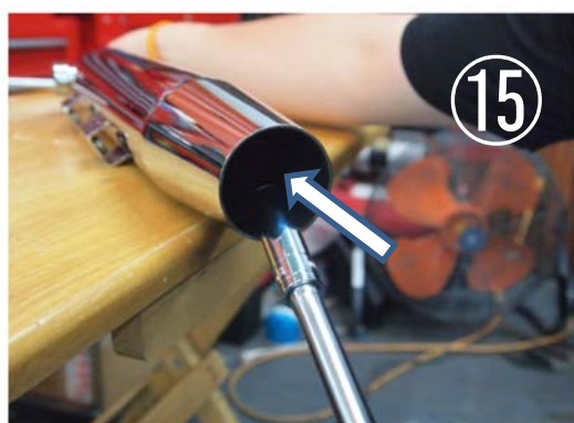
15 ボルトにナットを取り付ける
