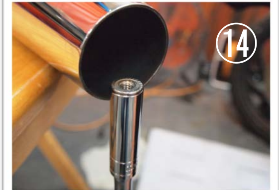
14 ナットを落とさないように慎重にマフラーに挿入
