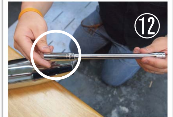
12 エクステンションバーに12mmディープソケットを装着
