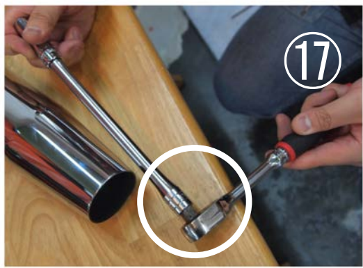
一度工具を抜きラチェットハンドルを装着
